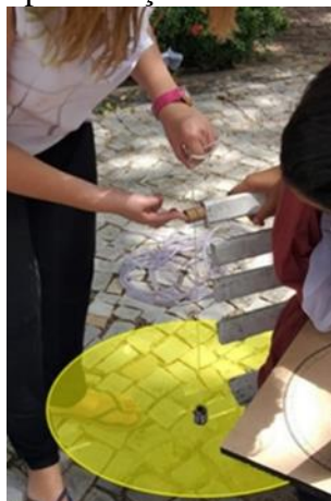
Figura 9 – Representação de uso do fio de prumo
