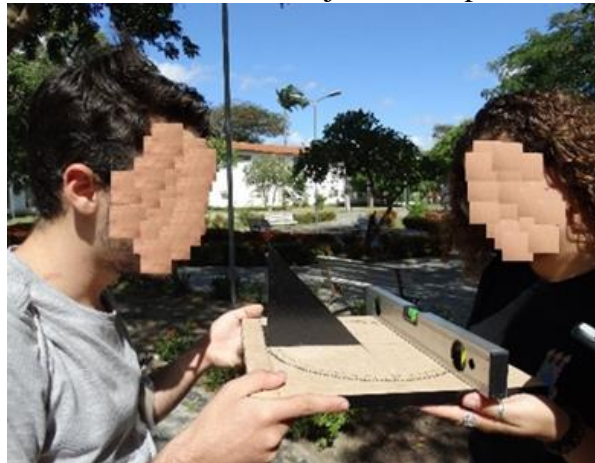
Figura 4 – Posicionamento do instrumento jacente no plano com o auxílio das mãos
